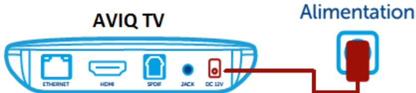
Connectez le cordon d'alimentation dans le décodeur AVIQ TV, puis le transformateur dans une prise 230V. Le décodeur s'allume de suite.
